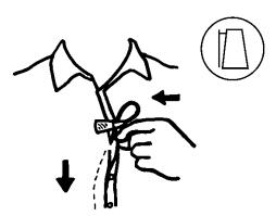
SHIRT-HOLDER. PUT THE MIC IN THE SHIRT-HOLDER AND PLACE IT BEHIND THE FRONT PLACKET OF THE SHIRT. CLIP THE HOLDER CLOSE TO A BUTTON AND ADJUST THE STRAIN RELIEF AT THE BACK.
