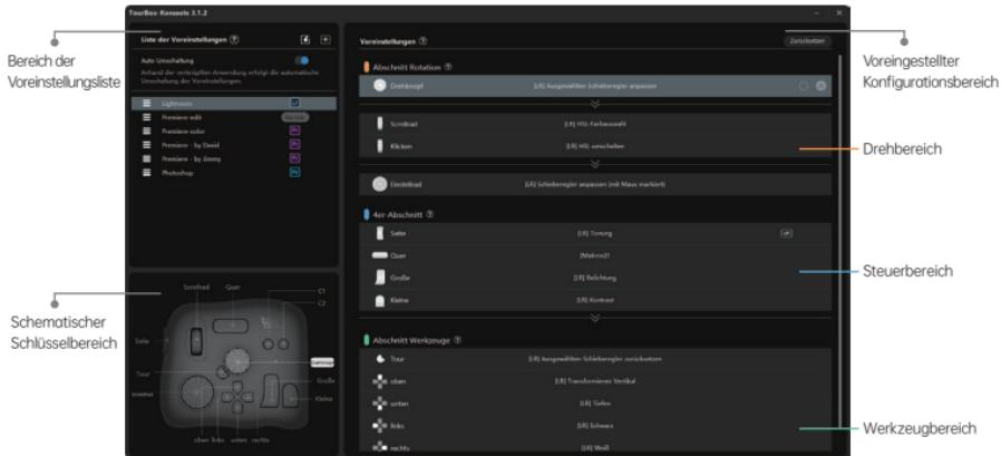
Der Drehbereich kann zur schnellen und präzisen Einstellung der Parameter verwendet werden. Er kann einzeln oder in Kombination mit anderen Tasten verwendet werden.
